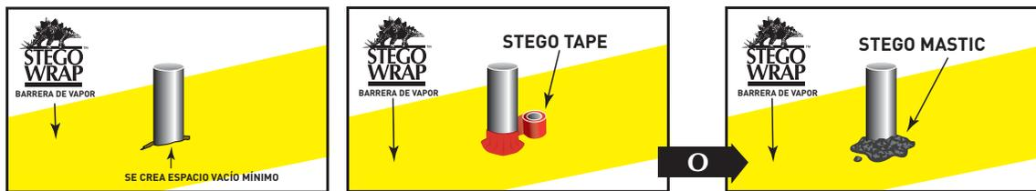
**DETALLE DE REPARACIÓN DE PENETRACIÓN DE TUBERÍAS STEGO WRAP:**
