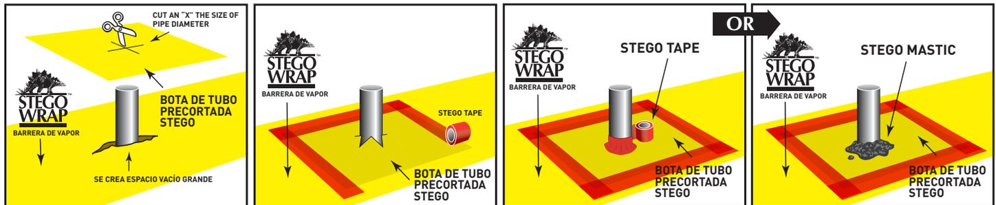
FIGURA 5: SELLADO DE PENETRACIÓN MÚLTIPLE DE TUBERÍAS
