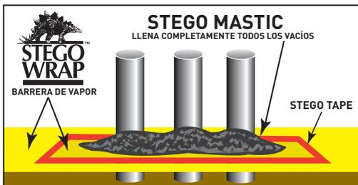
**SELLADO DE PENETRACIÓN DE TUBERÍAS MÚLTIPLES:**
